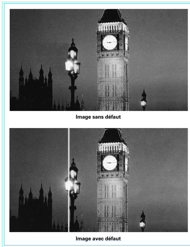
Figure 20 – Défaut sur image (smearing) : colonne surbrillante (doc. BTS)
