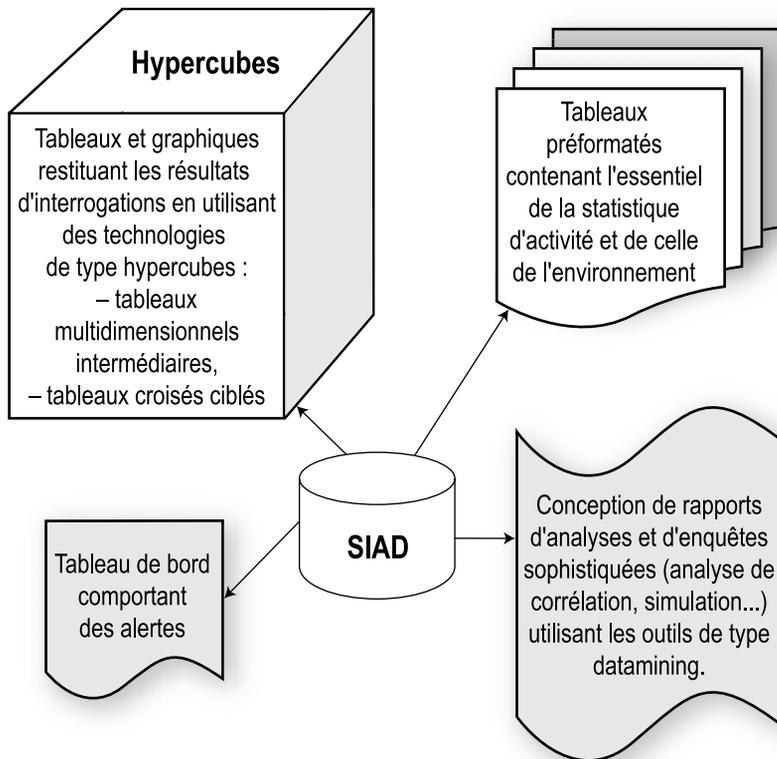
**Figure 12 : Le Système Interactif d'Aide à la Décision (SIAD) fournit des d'outils de différents types**
