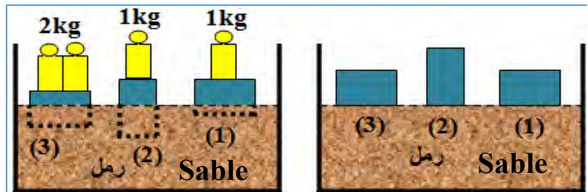
surface du sable fin et bien sec, puis mettre les masses marquées sur les morceaux de bois qui se plongent dans le sable.
