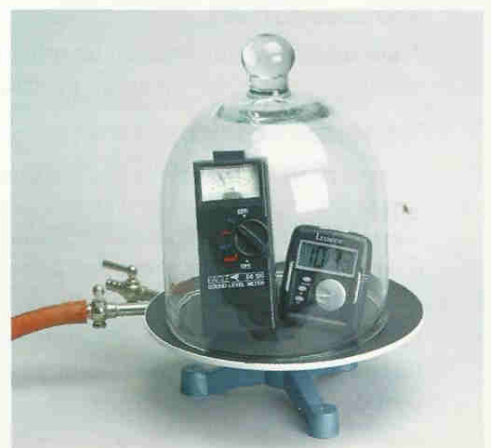
Doc. 9 Dispositif expérimental pour étudier la propagation du son.
