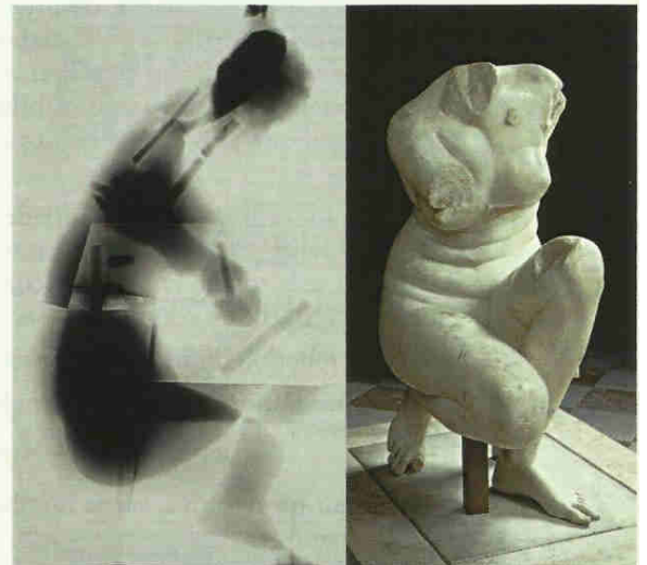
Doc. 9 Gammagraphie de la statue de la déesse Aphrodite, exposée au musée du Louvre. On observe les consolidations intérieures de cette statue de marbre (inserts métalliques). Une gammagraphie consiste à réaliser un cliché radiographique en utilisant les rayons \gamma émis par un échantillon radioactif.
